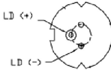
FIGURE 12: PIN SELECTION FOR EMITTER CIRCUIT
