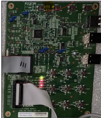
**Figure 5.** T114 Debug Module.
