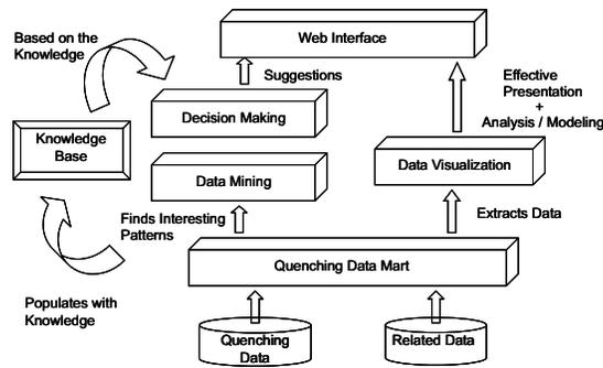
Fig. 2. QuenchMiner<sup>TM</sup> Architecture
