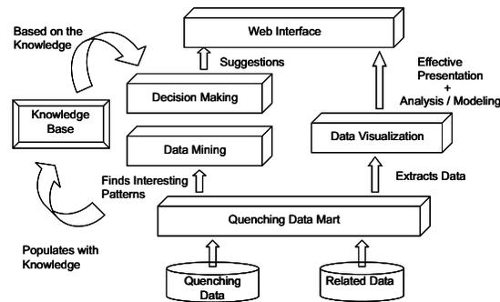
Fig. 2. QuenchMiner<sup>TM</sup> Architecture
